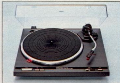
SL-Q 202 Halbautomatischer Plattenspieler mit quartzeregelmtem Direktantrieb. Hochwertiger Magnettonabnehmer EPC-U25. Gleichlaufschwankungen \pm 0,035\% . Gehäusefarbe: schwarz + silber.
