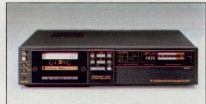
RS-M 280 3-Kopf-Stereo-Cassetten-Deck mit Hinterbandkontrolle. 3 Motoren, Reineisenbandbetrieb, Dolby, Doppel-Capstan-Antrieb, quarz geregelter Direktantrieb der Tonwellen, Leichthubtasten. Übertragungsbereich 20 Hz-20 kHz bei Reineisenband. 2farbiges FL-Aussteuerungsanzeige mit „peak-hold“, elektronisches Bandzählwerk. Eichoszillatoren 400 Hz/8 kHz. Gehäusefarbe: schwarz.
